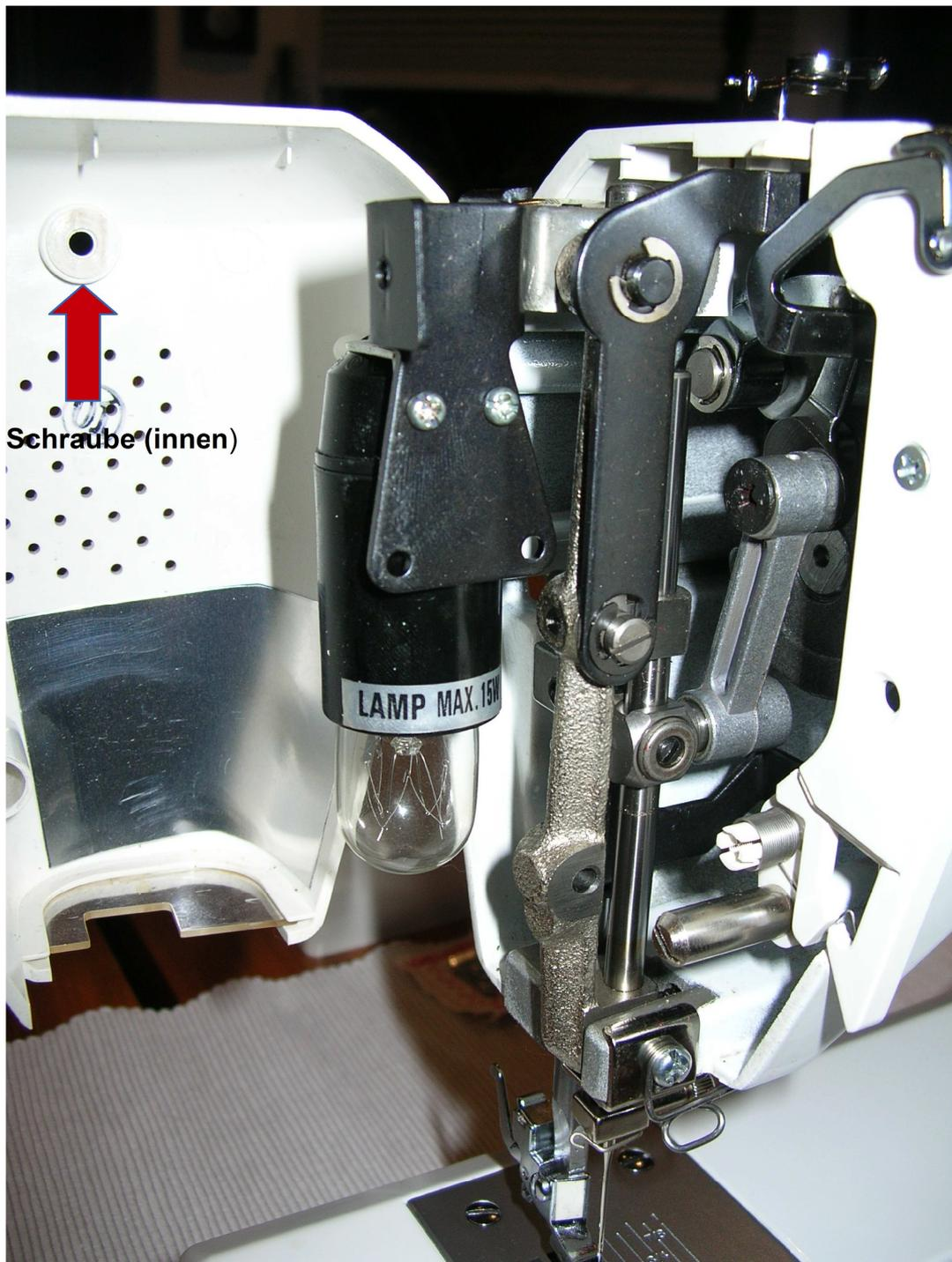
...bei manchen Maschinen ist der Lampendeckel mittels Scharnier angebaut und wird nach dem Lösen der Schraube einfach nach hinten geklappt, wie bei diesem Beispiel...
