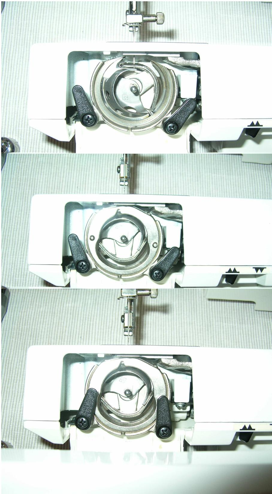
...und zuletzt die Spulenkapsel einsetzen...
