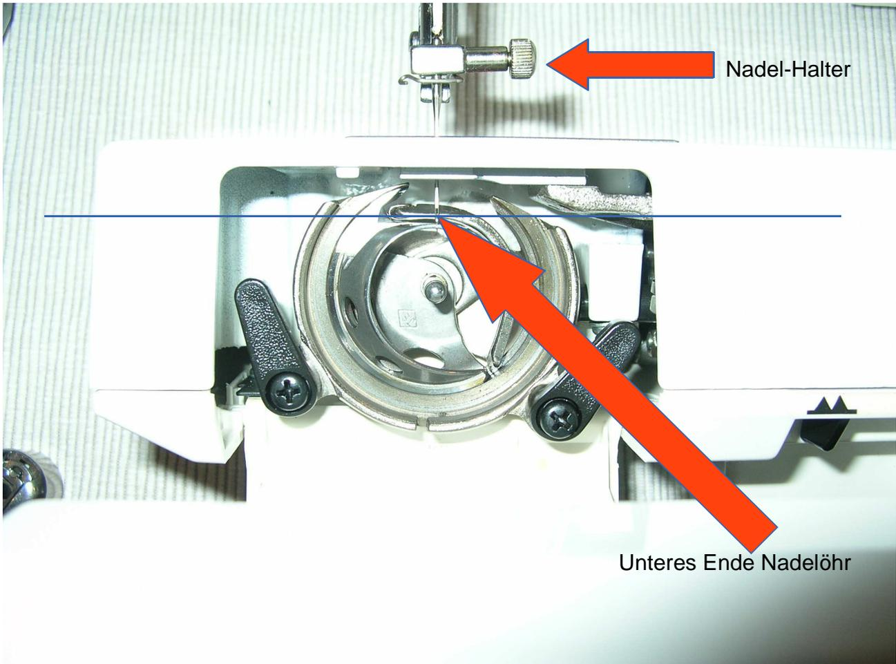
...das unter Ende des Öhrs muss entsprechend der eingezeichneten Linie positioniert werden...dann die Halteschraube wieder anziehen...nicht „anknallen“!
