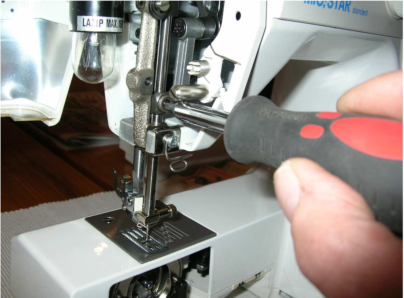
...die Nadelstange mit dem Handrad in eine Position bringen, in welcher die Halteschraube gut zugänglich ist...und diese mit dem Innensechskant-Bit soweit lösen, dass die Nadelstange nicht lose ist, aber ohne Schwierigkeit verschoben werden kann...
