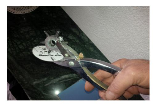
Die grosse Scheibe mit einem Locheisen oder einem Bohrer an der Markierung in der Mitte ebenfalls lochen...
